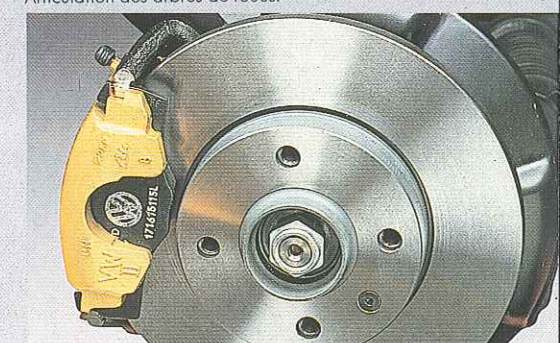
Freins à disques du train avant.
