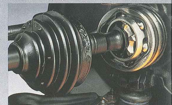
Articulation des arbres de roues.
