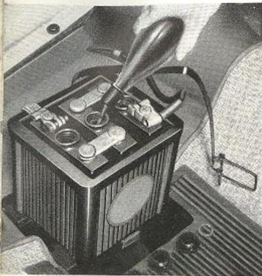
El ácido debe llegar a 15 mm encima de las placas. En caso de evaporación o pérdida de líquido es absolutamente indispensable añadir exclusivamente agua destilada. Añadir ácido únicamente si ha habido alguna pérdida del líquido. Finalmente debe comprobarse el grado de densidad del ácido y asegurar la concentración debida.
