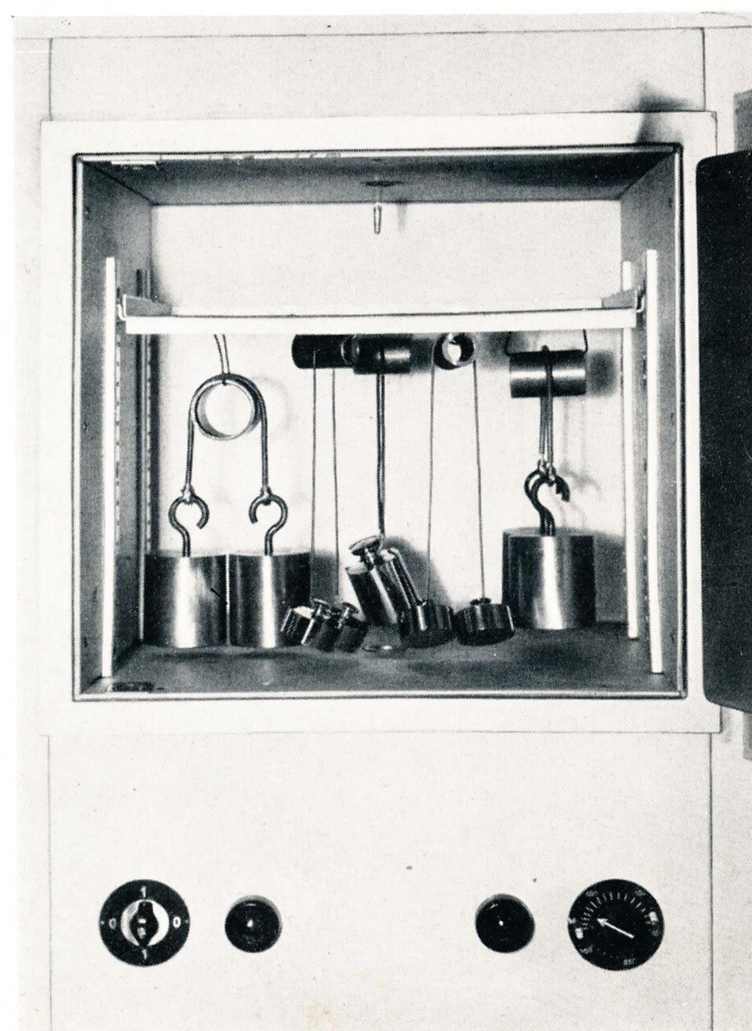
Mit Gewichten belastet werden beim Wärmedruckversuch die Prüfstücke, die 48 Stunden über einem Dorn im Wärmeofen bei  $70^{\circ}\text{C}$  hängen. Dorndurchmesser und Gewicht sind entsprechend dem Nennquerschnitt der Leitungen nach DIN genormt.
