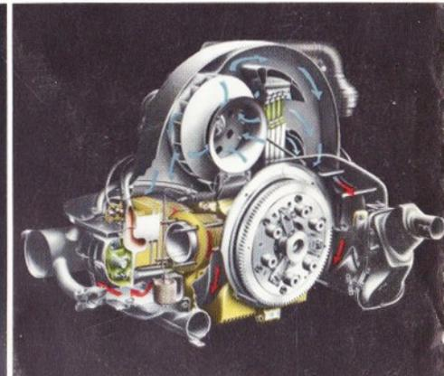
**Moteur** placé à l'arrière, refroidi par air, 4 temps, 4 cylindres à plat opposés deux à deux. Alésage 77 mm. Course 64 mm. Cylindrée 1192 cmc. 30 CV à 3400 t/min. Rapport de compression 6,6. Soupapes en tête
