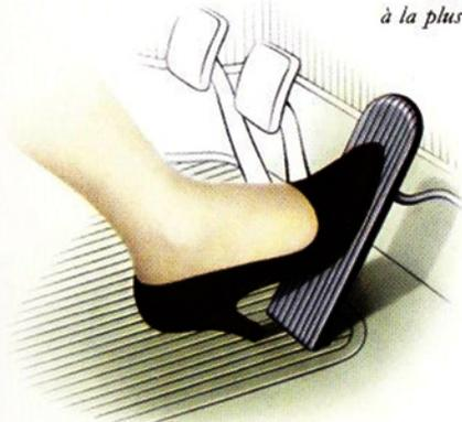
La large pédale d'accélération est garnie de caoutchouc antidérapant. Elle se manœuvre avec la plus grande facilité et a été conçue pour que le pied y repose confortablement; les souliers de dames eux-mêmes s'y adaptent parfaitement. Le plancher de la voiture ainsi que l'avant sont garnis de caoutchouc teinté dans la masse.
