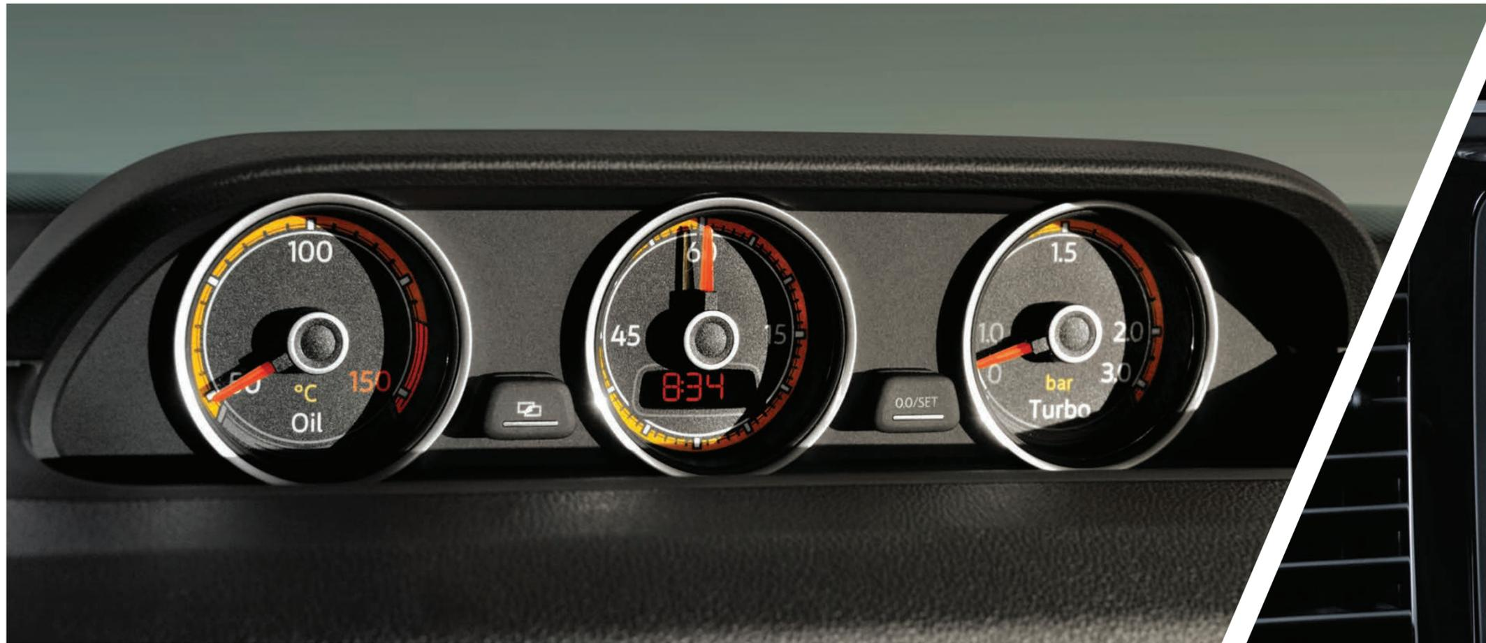
Beetle prácticamente cobra vida cuando estás al volante y te comunica varios de sus signos vitales desde el llamativo **cuadro de instrumentos en consola central con tres relojes (temperatura de aceite, cronómetro, presión de turbo) con detalles en amarillo |D**, otro distintivo más de su impresionante diseño.
