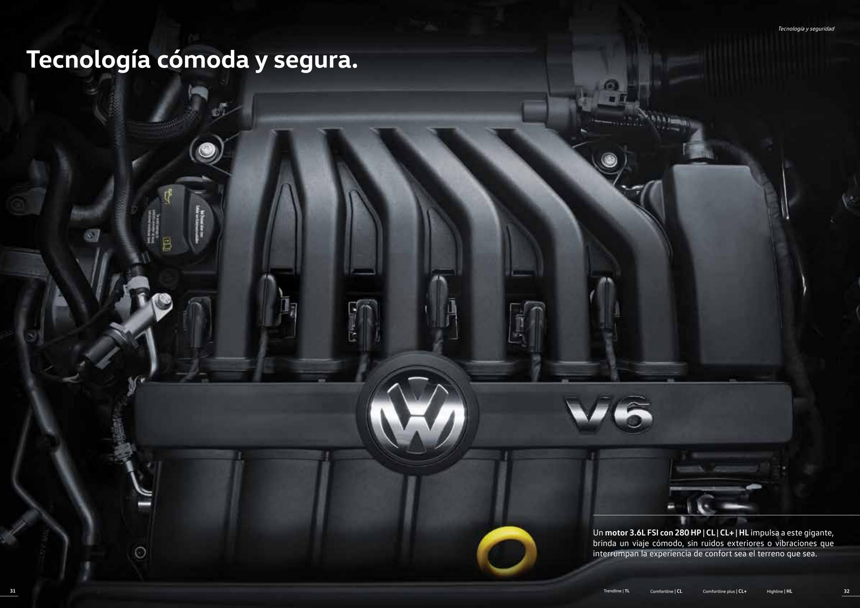
Un motor 3.6L FSI con 280 HP | CL | CL+ | HL impulsa a este gigante, brinda un viaje cómodo, sin ruidos exteriores o vibraciones que interrumpen la experiencia de confort sea el terreno que sea.
