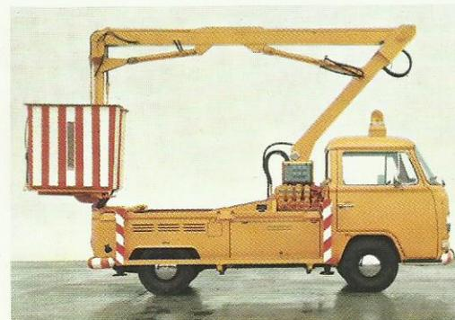
VW-Pritschenwagen mit hydraulischer Hebebühne (Ruthmann-Steiger Typ V90)
