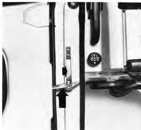
Les **quatre portes** sont en outre – également si la porte est fermée de l'intérieur – verrouillables avec les leviers intérieurs de portes:
