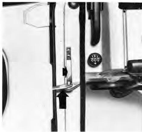
Les **quatre portes** sont en outre – également si la porte est fermée de l'intérieur – verrouillables avec les leviers intérieurs de portes:
