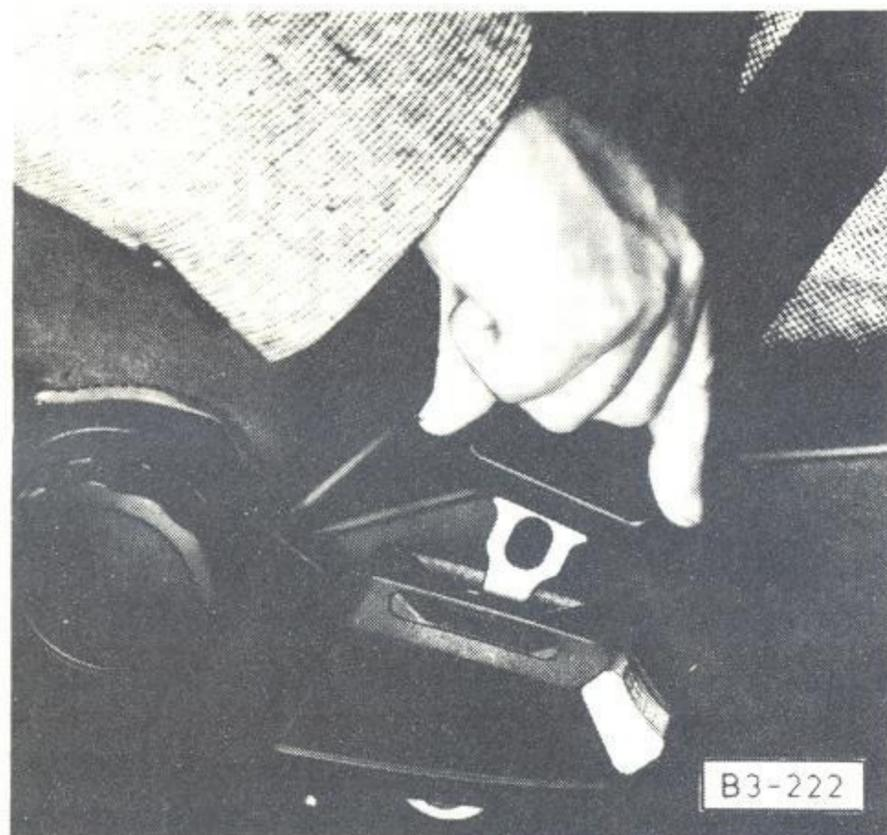
**El cinturón automático** se adapta por sí solo a cualquier talla y a cualquier posición del asiento, permitiendo al usuario moverse con toda libertad siempre que sea lenta la acción a que se someta el cinturón. Cualquier frenazo brusco bloqueará el cinturón. El mecanismo de bloqueo del enrollador automático bloquea el cinturón también al conducir por pendientes empinadas y al tomar con velocidad las curvas.
