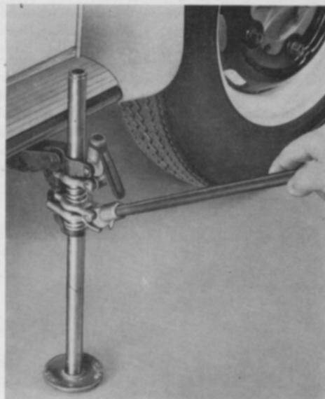
Serrez ensuite tous les boulons jusqu'à ce que la roue (centrée par les têtes bombées des boulons) porte uniformément sur le moyeu.
