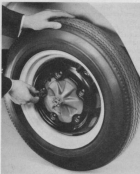
trous des boulons de la roue à monter se trouvent à peu près en face des trous filetés des boulons de fixation.
