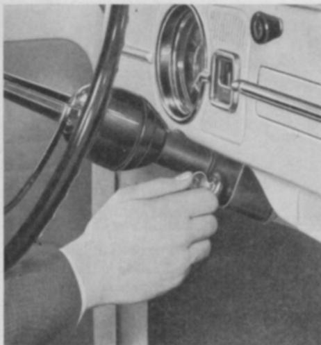
Avant de tourner la clé de contact, assurez-vous que le levier des vitesses est au point mort.
