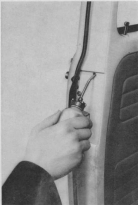
des capots. N'oubliez pas d'essuyer l'huile qui aurait pu couler sur les charnières des capots. Au besoin, graphitez le cylindre de fermeture des serrures de portes. Il suffit de plonger la clé dans du graphite et de la tourner plusieurs fois dans la serrure. Graissez légèrement les surfaces de frottement des gâches de serrure.
