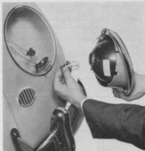
Replacez le capuchon de telle façon que la languette de contact s'applique sur le culot de l'ampoule du feu de position.
