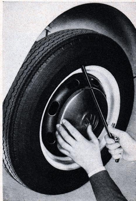
Infilare la leva d'azionamento nello snodo superiore (A) del martinetto e sollevare la vettura. Svitare completamente le viti di fissaggio e staccare la ruota.
