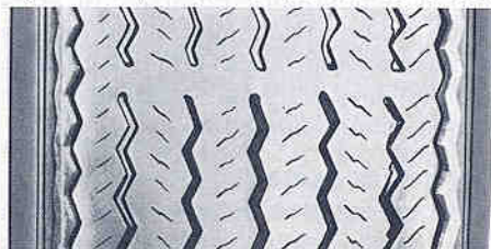
Indicateur visible - Bande de roulement usée
