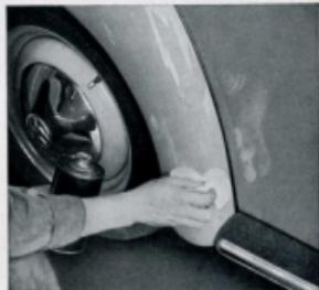
möglichst bald nach Beendigung der Fahrt erfolgen. Unterwegs steht im allgemeinen nur Benzin zur Verfügung, das mit einem weichen Lappen aufgetragen werden kann. Besser eignet sich Petroleum oder Terpentinöl. Anschließend werden die behandelten Stellen mit schwacher, lauwarmer Seifenlösung gewaschen und sauber abgespült, um alle Spuren des Reinigungsmittels zu entfernen.
