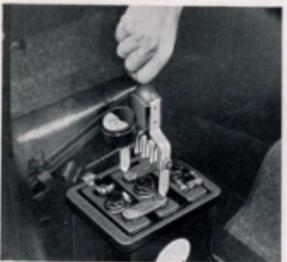
Die Säure soll etwa 15 mm über der Plattenoberkante stehen. Bei Verlusten durch Verdunstung darf nur destilliertes Wasser nachgefüllt werden. Säure wird nur ergänzt, falls Verluste durch Auslaufen entstanden sind. Anschließend ist die Dichte zu prüfen und gegebenenfalls auszugleichen.
