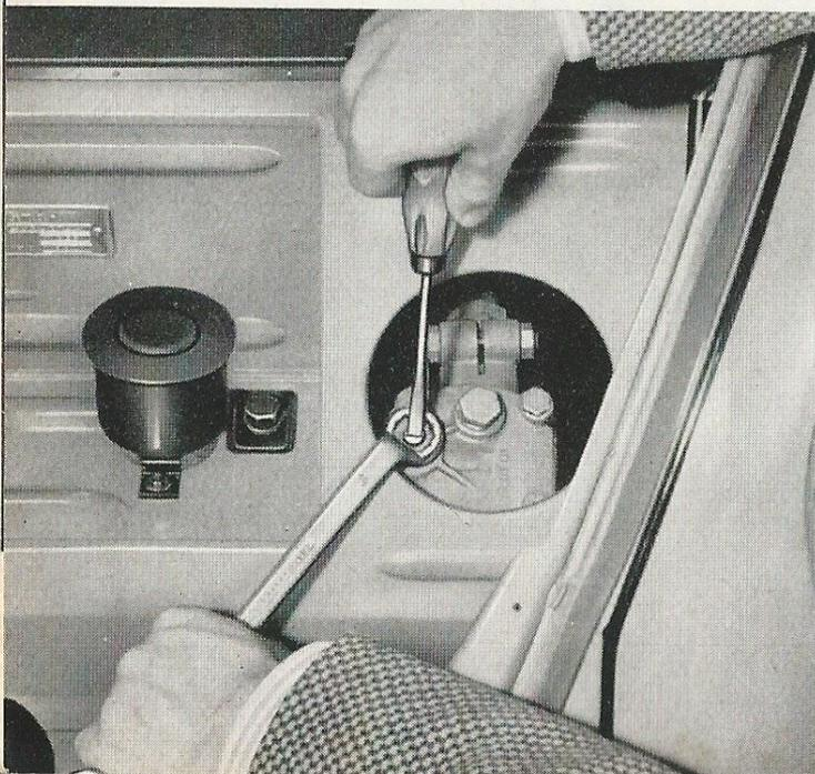
jusqu'à ce que la vis sans fin n'ait plus de jeu axial perceptible. Une fois le réglage terminé, resserrez le boulon de calage du fourreau.
