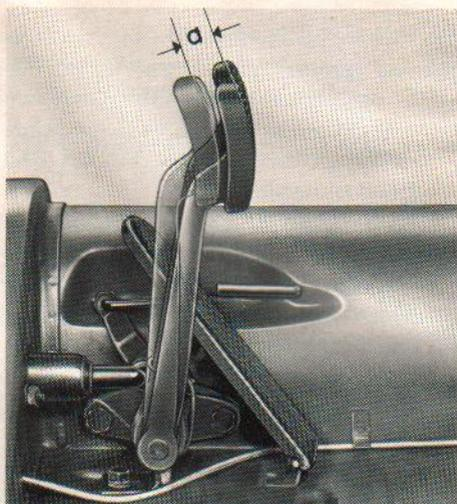
Am oberen Ende des Fußhebels gemessen soll das Kuplungsspiel 10 bis 20 mm (a) betragen. Es läßt sich mit der Nachstellmutter des Kupplungsseiles am Hebel der Ausrückwelle einstellen:
