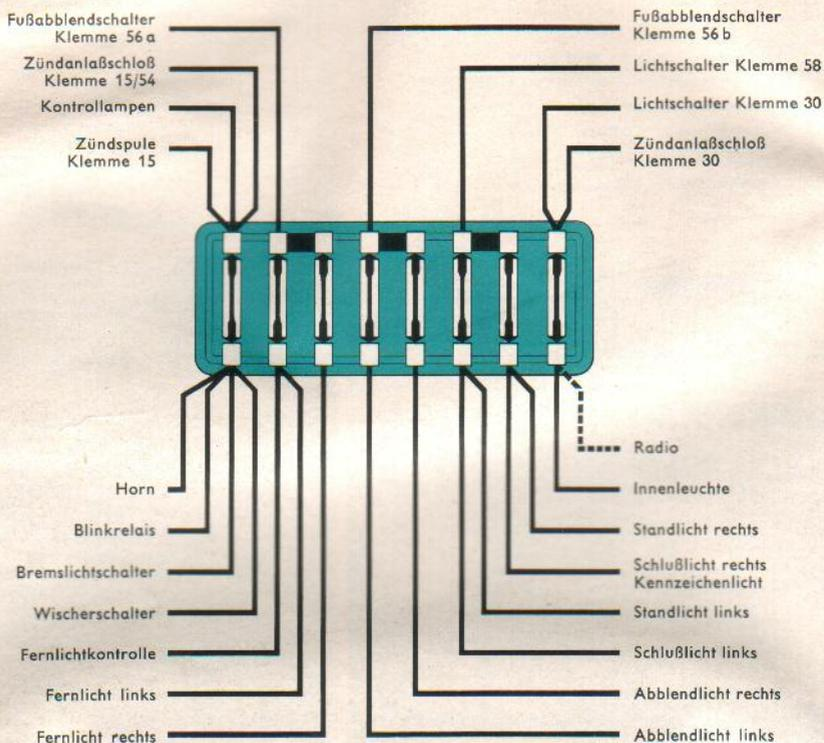
**Sicherungsdose unter dem Instrumentenbrett**
