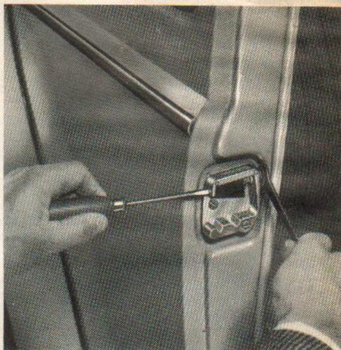
3 – Nachstellschraube mit dem Schraubenzieher drehen, und zwar links-herum bei klappernder und rechts-herum bei klemmender Tür. Meist genügt schon eine viertel bis halbe Umdrehung, um den Anschlag für den Keil in die richtige Lage zu bringen.
