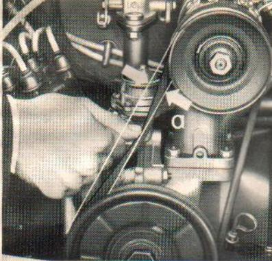
Die Prüfung ist sehr einfach: Er muß sich durch kräftigen Dauermendruck um das Maß  $a$  nach innen drücken lassen.
