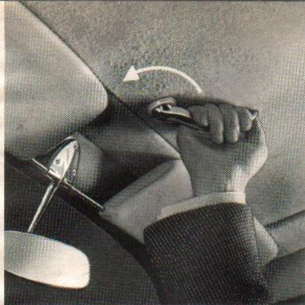
geöffnete Verdeck sieht dann nicht nur besser aus, sondern wird auch durch richtige Lage der Falten geschont. Sonnendach schließen: Griff zunächst nach links, Dach nach vorn ziehen, bis der Verschlusshaken in die Öffnung faßt, und Griff kräftig wieder nach rechts legen.
