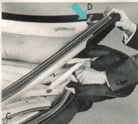
6 – Kappen der Verdeckverschlüsse über die Führungen legen und Hebel spannen (D).
