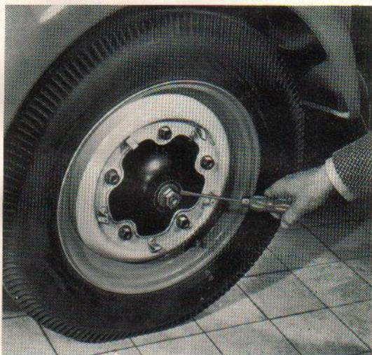
Bremstrommel quer zur Fahrtrichtung darf kein merkliches Spiel festzustellen sein. Zu loses oder zu festes Einstellen kann in kürzester Zeit zur Zerstörung der Vorderradlager führen.
