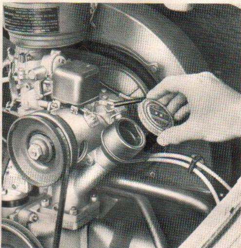
Der Motor wird nun mit  $2\frac{1}{2}$  Liter HD-Öl befüllt.
