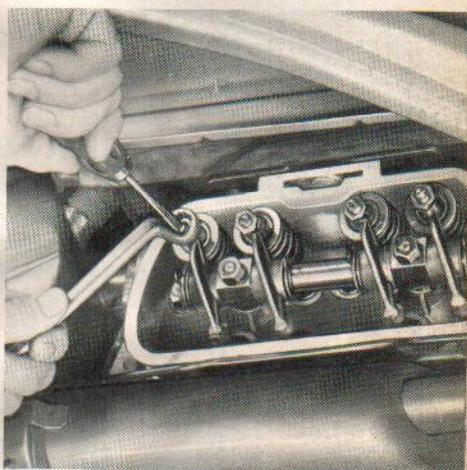
Die Anordnung der Zylinder ist aus den in die Abdeckbleche im Motorraum eingeprägten Zahlen 1 bis 4 zu ersehen.
