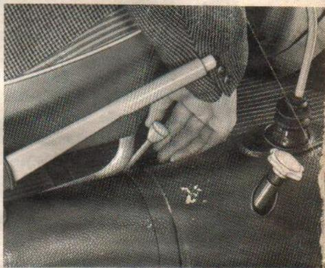
Die Neigung der Rückenlehne beider Vordersitze läßt sich durch Umlegen eines Hebels so verändern, daß drei verschiedene Stellungen möglich sind.
