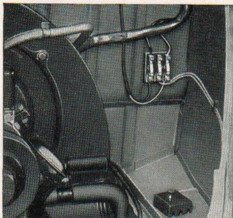
Nach Durchbrennen einer Sicherung genügt es nicht, diese nur durch eine neue zu ersetzen. Vielmehr ist die Ursache des Kurzschlusses bzw. der Überlastung festzustellen. Auf keinen Fall dürfen mit Stanniol oder Draht geflickte Sicherungen verwandt werden, da dann ernstere Schäden an anderer Stelle der Anlage auftreten können. Es empfiehlt sich, stets einige Ersatzsicherungen (8/15 Ampere) mitzuführen.
