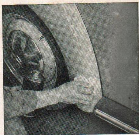
möglichst bald nach Beendigung der Fahrt erfolgen. Unterwegs steht im allgemeinen nur Benzin zur Verfügung, das mit einem weichen Lappen aufgetragen werden kann. Besser eignet sich Petroleum oder Terpentinöl. Anschließend werden die behandelten Stellen mit schwacher, lauwarmer Seifen- oder Waschmittellösung gewaschen und sauber abgespült, um alle Spuren des Reinigungsmittels zu entfernen.
