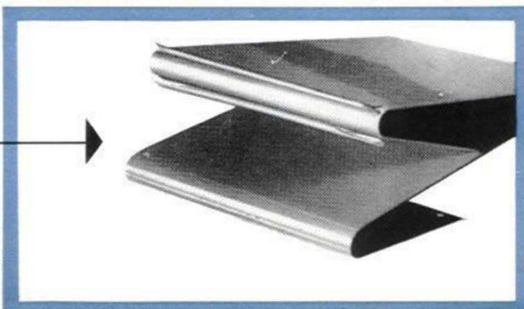
Die Elastizität, welche gleichzusetzen ist mit der Schlagfestigkeit (teilweise auch mit der Haftfestigkeit), erfährt eine zweite Prüfung im Schlagprüfgerät. Durch ein Fallgewicht wird dem Prüfblech auf der Lackseite eine Ausbeulung beigebracht, ähnlich einer Steinschlagbeschädigung, wobei der Lack keineswegs absplittern oder auch nur einreißen darf.
