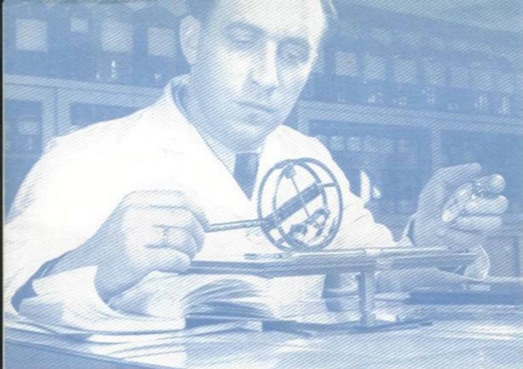
Das zur Anwendung kommende Prüfgerät ist ein Schaukel-Härteprüfer. Weil dieses auf die waagrecht liegende Lackprobe aufgesetzte Prüfgerät sehr empfindlich auf Luftzug reagiert, wird es zur Erzielung genauer Meßergebnisse durch eine transparente Kunststoffhaube abgedeckt, sobald es in Schwingungen versetzt ist. Die Anzahl der Schwingungen, die zwischen 10 und 100 liegen kann, wird mittels Stoppuhr gemessen und ergibt einen genauen Vergleichswert für die Lackqualität.
