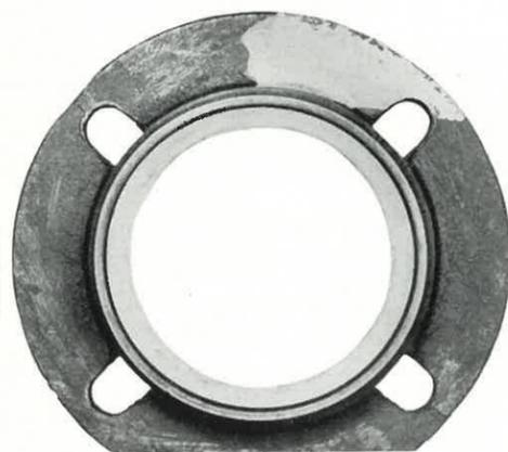
Zylinder von unten, Aussparungen für Stiftschrauben hufeisenförmig
