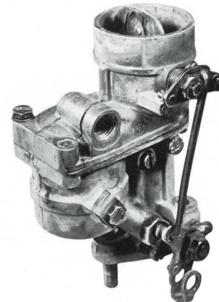
Gewindebohrung für Kraftstoffleitung quer eingerissen
