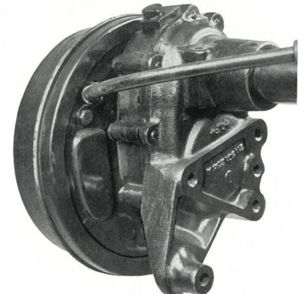
Untersetzungsgetriebe / Ausführung II
