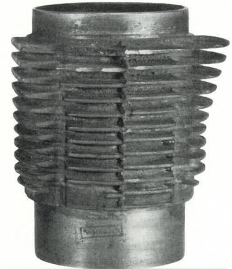
Zylinder mit kurzem Schaft (Aussparungen für Stehbolzen offen)
