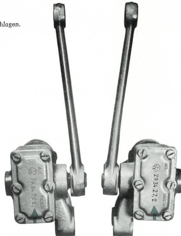
**Lenkgetriebe mit Lenkstockhebel**
