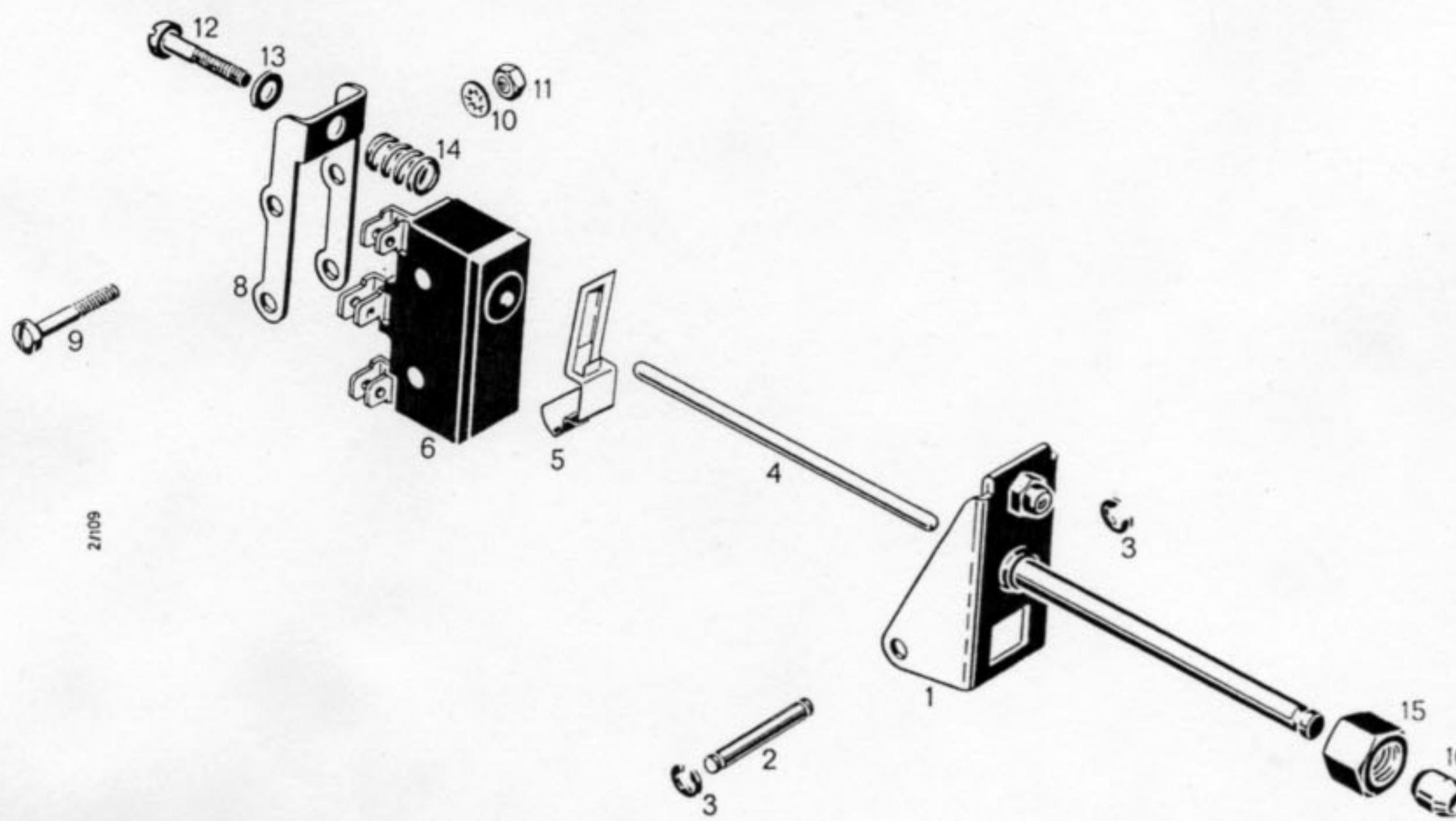
Beim Ausbau des Thermoschalters nach Lösen der Überwurfmutter (15) diesen vorsichtig hin- und herdrehend aus dem Gewindestutzen im Wärmetauscher herausziehen, ohne das Fühlrohr zu verbiegen. Ggf. Lösungsmittel (Caramba) verwenden. Beim Zusammenbau ist darauf zu achten, daß das Fühlrohr nicht verbogen ist und der Quarzstab (4) nicht klemmt. Das Einstellager (8) muß leicht drehbar im Schalterlager (1) sitzen.
