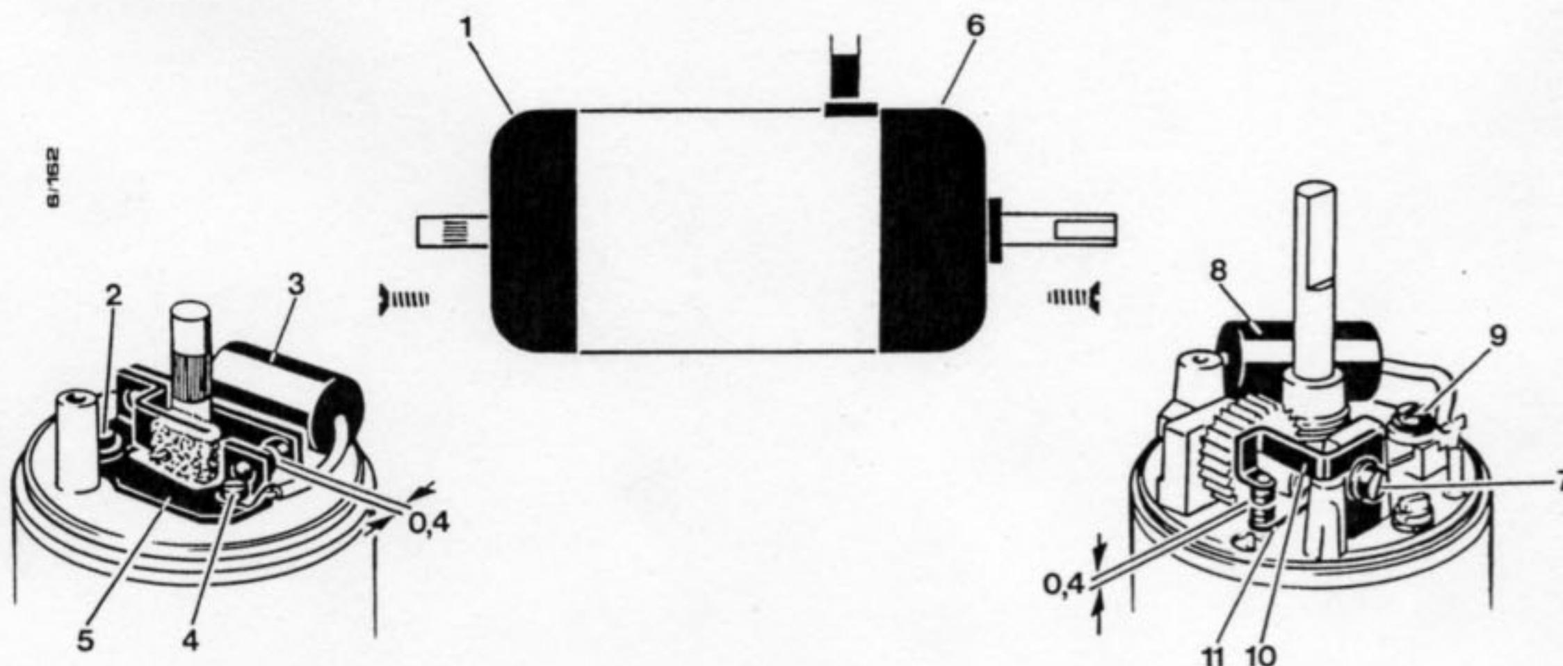
**Einstellen bzw. Austauschen des Unterbrecherkontakte für die Zündung.**
