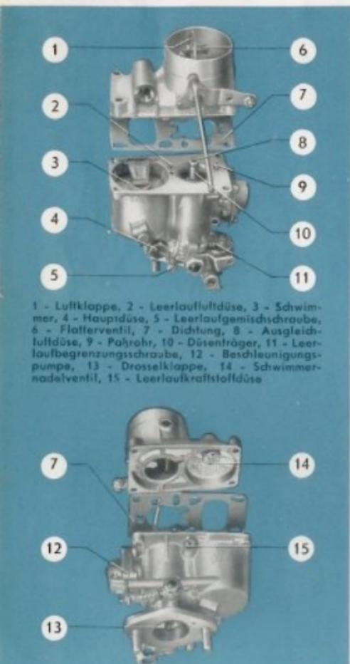
1 - Luftklappe, 2 - Leerlaufdüse, 3 - Schwimmer, 4 - Hauptdüse, 5 - Leerlaufgemischschraube, 6 - Flatterventil, 7 - Dichtung, 8 - Ausgleichdüse, 9 - Paßrohr, 10 - Düsenräger, 11 - Leerlaufbegrenzungsschraube, 12 - Beschleunigungspumpe, 13 - Drosselklappe, 14 - Schwimmernadelventil, 15 - Leerlaufkraftstoffdüse
