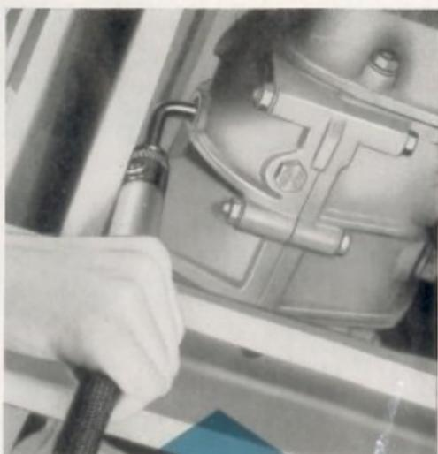
Anschließend werden **2 Liter Getriebeöl** aufgefüllt.
