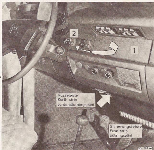
Blende (1) entfernen. Einschalter (2) nach Schaltplan (Seite 7) anschließen und in vorhandene Aussparung am Armaturenbrett von hinten einsetzen.
