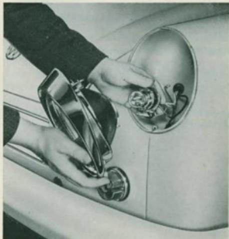
Verschlußkappe so aufsetzen, daß das Kontaktblech auf dem Sockel der Standlichtlampe aufliegt.
