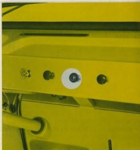
**Die Scheibenwischer** schalten Sie mit dem mittleren Zugschalter ein.
