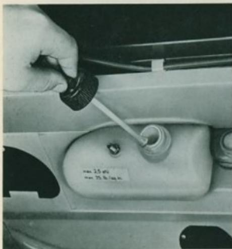
Die Scheibenwaschanlage betätigen Sie mit dem Knopf, der in den Zugschalter für die Scheibenwischer eingebaut ist. Sie arbeitet mit Druckluft, so daß Sie durch einmaliges Niederdrücken des Knopfes so lange Wasser auf die Wischfelder der Windschutzscheibe sprühen können, bis die Scheibenwischer das Blickfeld gut gereinigt haben.
