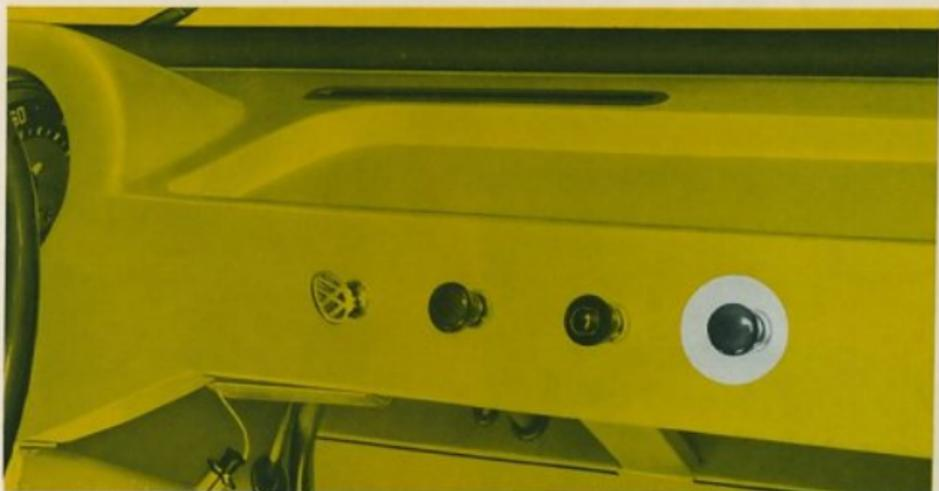
**Die Frischbelüftung** wird mit dem Zugknopf rechts an der Armaturentafel eingeschaltet. Je weiter Sie den Zugknopf herausziehen, um so größer ist die Luftmenge, die durch eine Düse am unteren Rand der Windschutzscheibe vor dem Fahrersitz eintritt.
