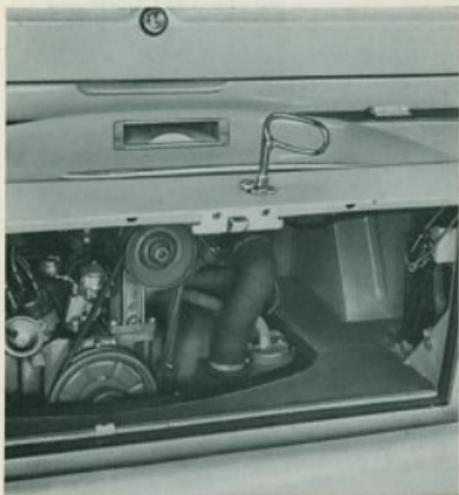
**Der vordere Deckel** ist am abgeschlossenen Wagen gegen unbefugtes Öffnen gesichert. Der Zugknopf zum Öffnen des Schloßes liegt links unter der Armaturentafel. Der Deckel springt unter Federdruck etwas auf und läßt sich ganz öffnen, wenn Sie den Sicherheitshaken neben dem Schloß nach oben drücken.
